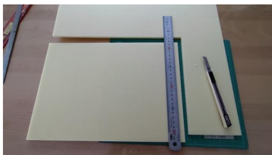
⑤ボードをカッターナイフで切り抜く（金尺を利用）
