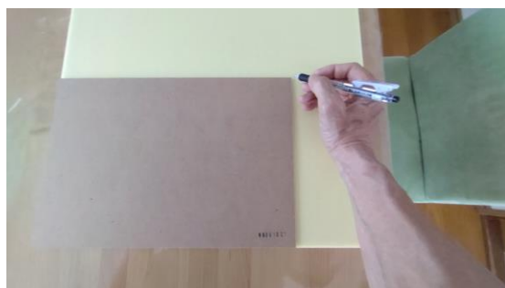
④ボードに裏板を当てて同じ大きさに線を引く
