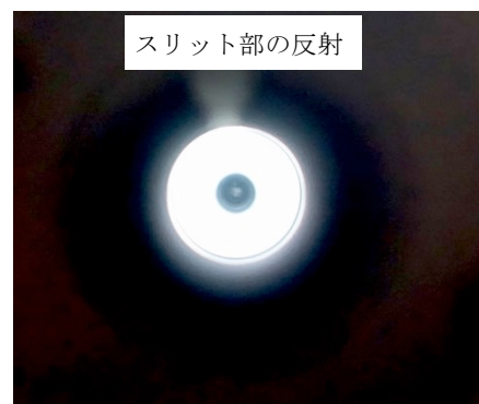
Fig.6 植毛紙挿入後のバッフル内面反射
